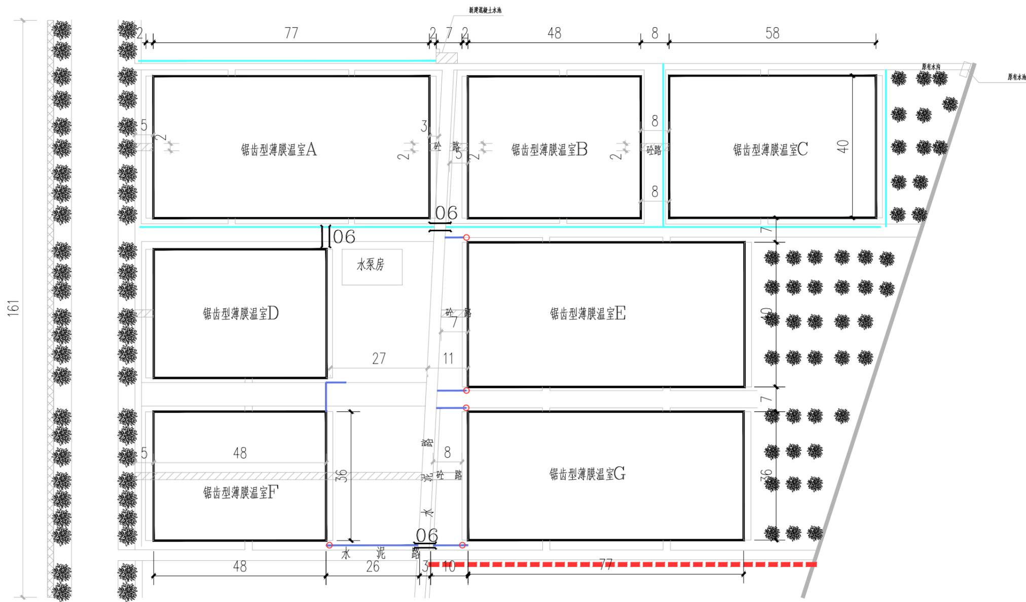
水渠1: 宽0.9米, 深1.0米, 总长108米, 土方开挖: 196m<sup>3</sup>.
