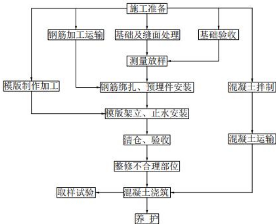
图 8-1 砼施工工艺框图
